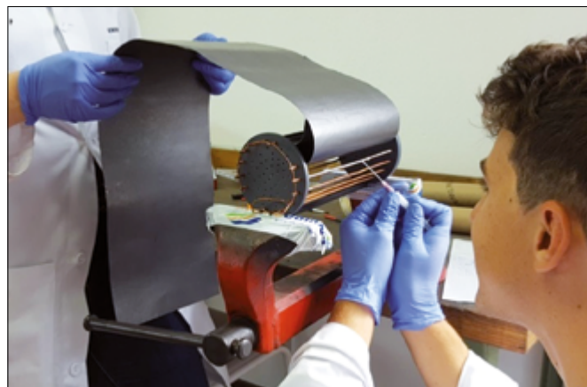
Abb. 9: Fertigung eines Prototyps der dreidimensionalen Papieranode (© EnviroChemie GmbH)
